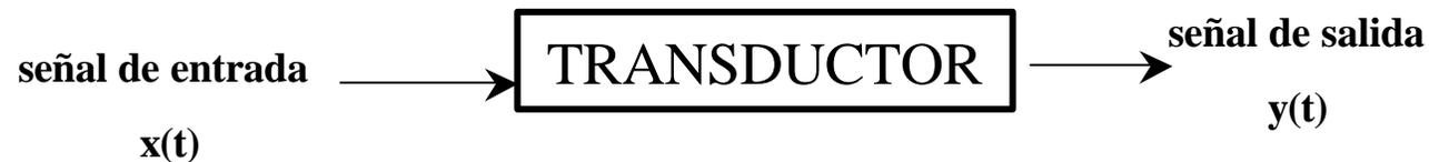
Los transductores normalmente utilizados para la toma de medidas son aquellos cuya señal de salida  $y(t)$  es de tipo eléctrico: tensión, intensidad, frecuencia,...
