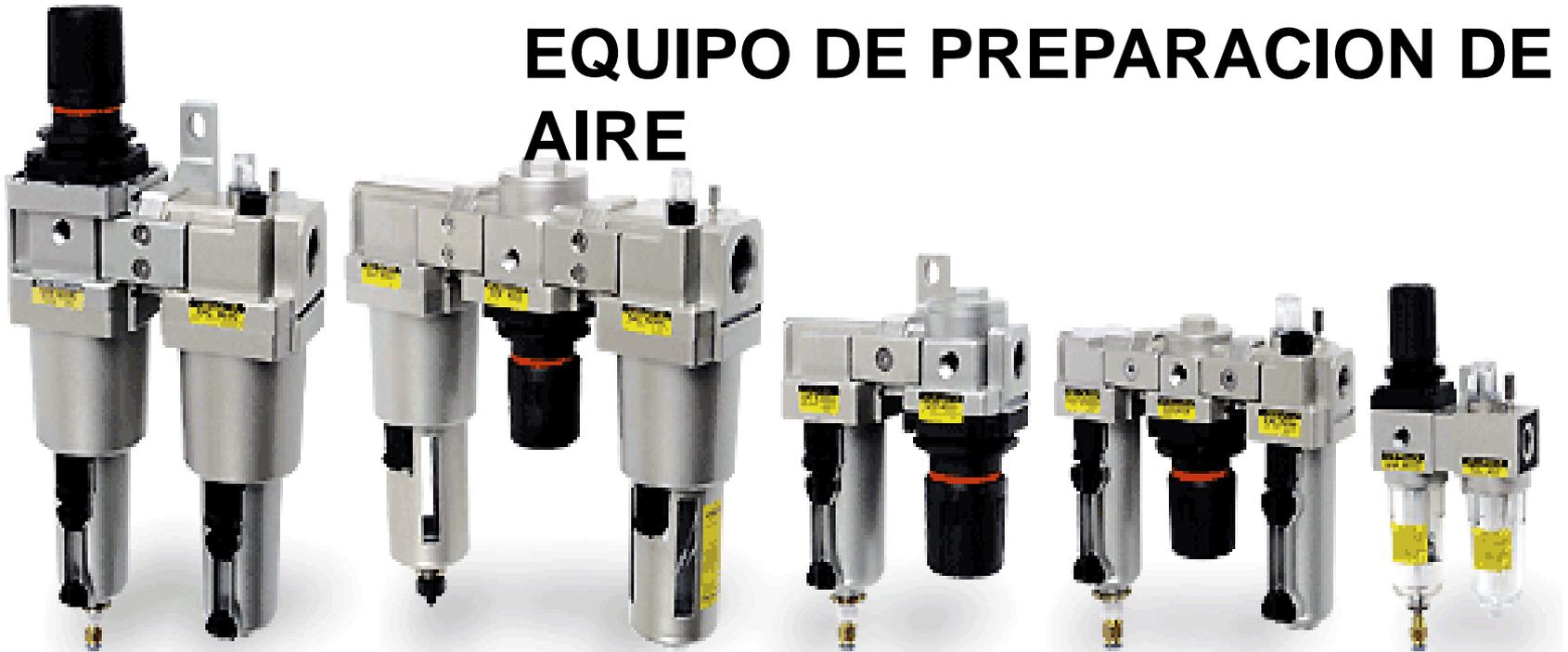
Las impurezas y el agua en suspensión se retienen mediante el uso de secadores y filtros. Después de estos, el aire comprimido pasa a el regulador o reductor de presión, mediante el cual se regula la presión del aire al nivel requerido. Finalmente para efectos de uso con válvulas, se efectúa la incorporación de aceite al aire mediante un lubricador, en conjunción con un pre filtro, reciben el nombre de unidad de mantenimiento
